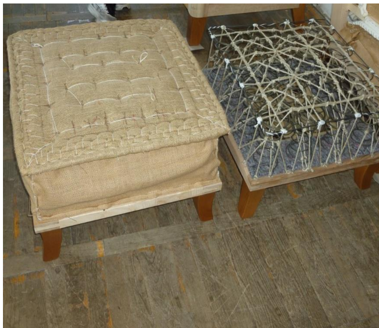
Obrázek 12. Část postupu výroby čalounění taburetu klasickou technologií
